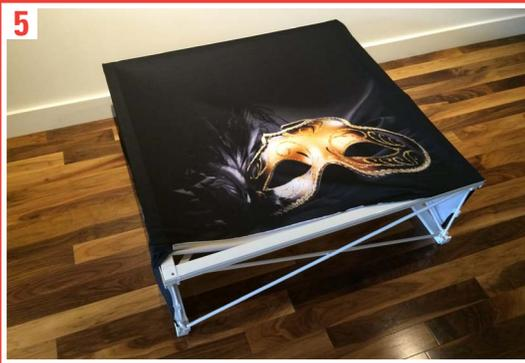
Coucher la structure au sol et installer le tissu sur la façade en commençant par les 4 coins. Insérer ensuite les 4 côtés du tissu en pressant le silicone dans la fente.
