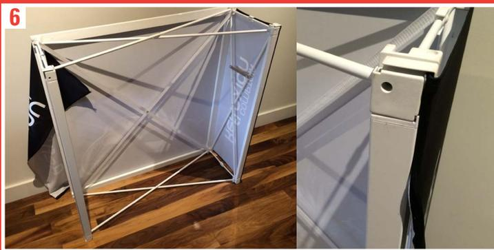
Mettre la structure debout et attacher les embouts dans la fente arrière.
